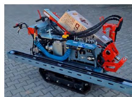
Die **einhängbare Werkzeugkiste** nimmt kleinere Ausrüstungsteile auf, um sie immer griffbereit zu halten.
